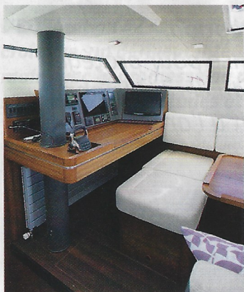
Timonerie. La table à cartes située en avant du carré devient un vrai poste de pilotage isolé du mauvais temps. On a la main sur le pilote automatique mais aussi sur les commandes moteur.
