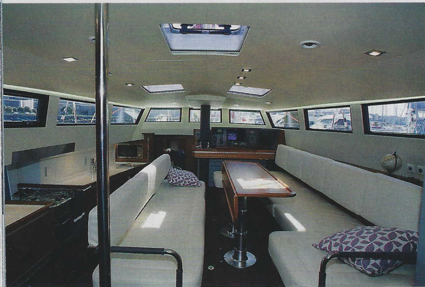
Salon de pont. L'appellation n'est pas volée : le carré surélevé permet de profiter à plein du rouf panoramique. La très grande cuisine en long est conçue pour être utilisée en navigation.
